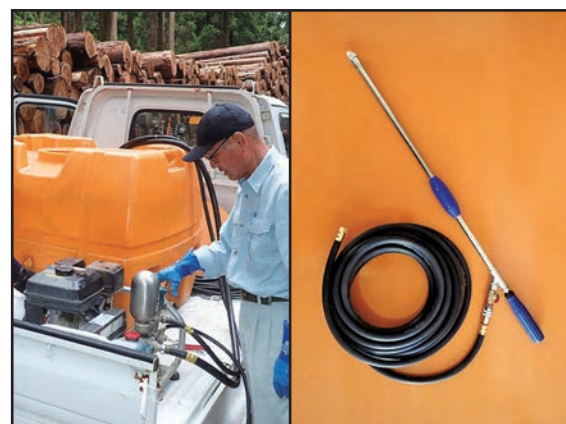
写真3 散布作業に用いた機材（左：動力噴霧機と貯水用タンク，右：噴口型ノズル）
